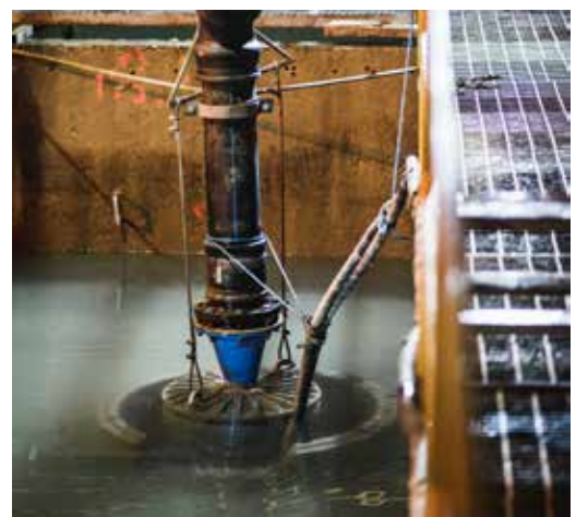
Flygt BS-2400HT:n moottori sijaitsee imuaukon alapuolella, jolla varmistetaan moottorin jäähdytys.
